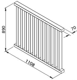
Mit Dübeln und wasserdichtem Leim verbunden
