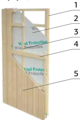
Die Gesamtelementstärke der Nordic+ Häuser beträgt 160 mm. Hier sehen Sie den Querschnitt eines Elements, damit Sie erkennen können, wie diese aussehen und woraus sie bestehen:
