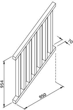
Mit Dübeln und wasserdichtem Leim verbunden
