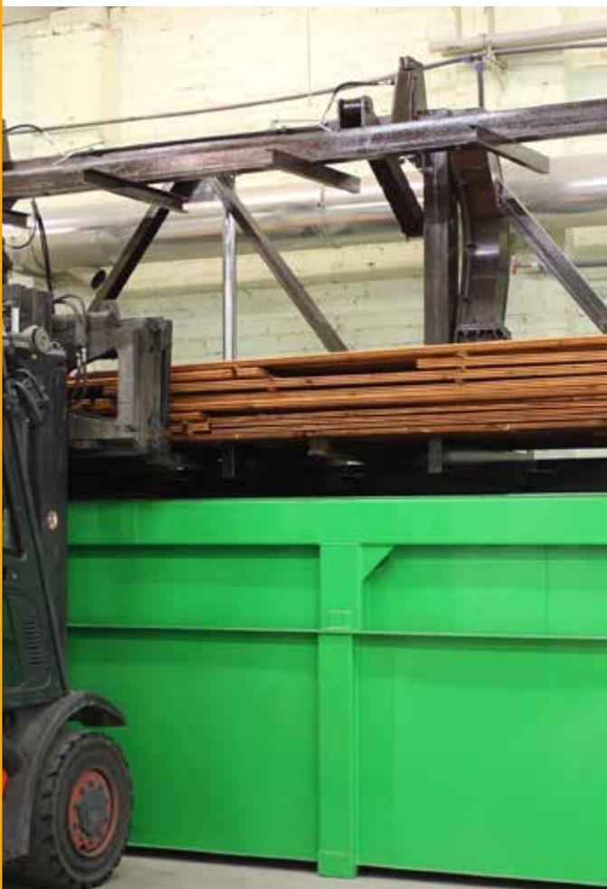
In Abhängigkeit von der Holzart oder der späteren Nutzung wenden wir verschiedene Varianten der Kesseldruckimprägnierung an.
