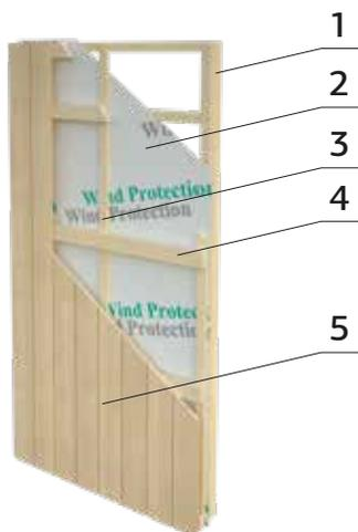
Der nebenstehende Querschnitt durch ein Wandelement zeigt dessen Aufbau. Die Wandstärke der Nordic+ Garagen beträgt 160 mm und setzt sich wie folgt zusammen:
