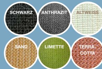
Das Coolfit®-Gewebe ist ein HDPE-Gewebe von 285 g/m<sup>2</sup>. Der Stoff hat eine offene Struktur und ist daher wasser- und winddurchlässig.
